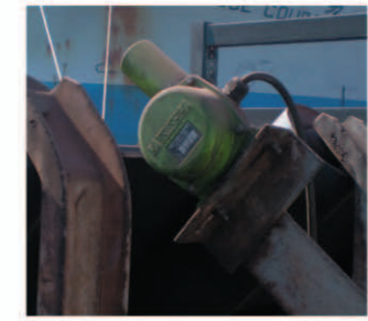
コンベヤ蛇行検知用 ベルト片寄スイッチ
